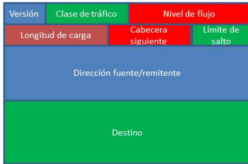
Fig. 1. Formato de cabecera IPv6 [3]
