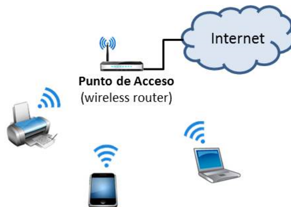
Figure 1.6 Esquema de una WLAN en el hogar
