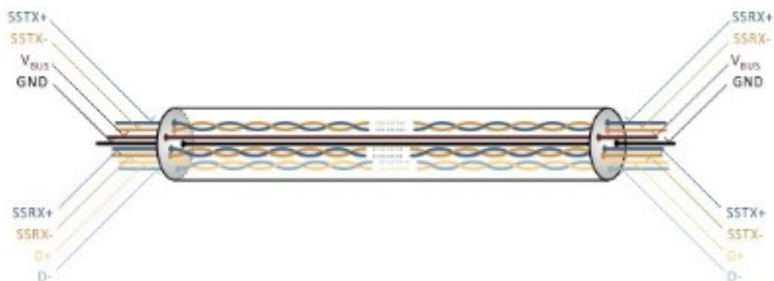
Schéma káblu špecifikácie USB 3.0
