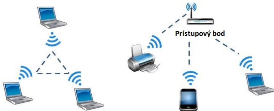
Obrázok 1.9 Sada nezávislej a infraštruktúrnej služby (BSS)
