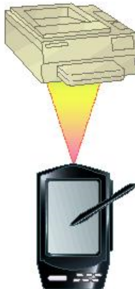
Obrázok 2 Komunikácia IrDA medzi PDA a tlačiarňou (bod - bod)
