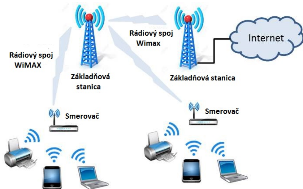
Obrázok 1.7 Schéma siete WiMaX
