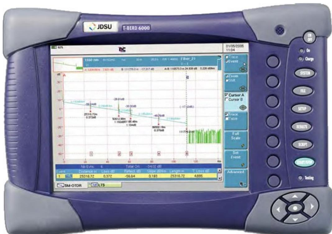
OTDR-Reflektometer (Optical Time Domain Reflectometer).
