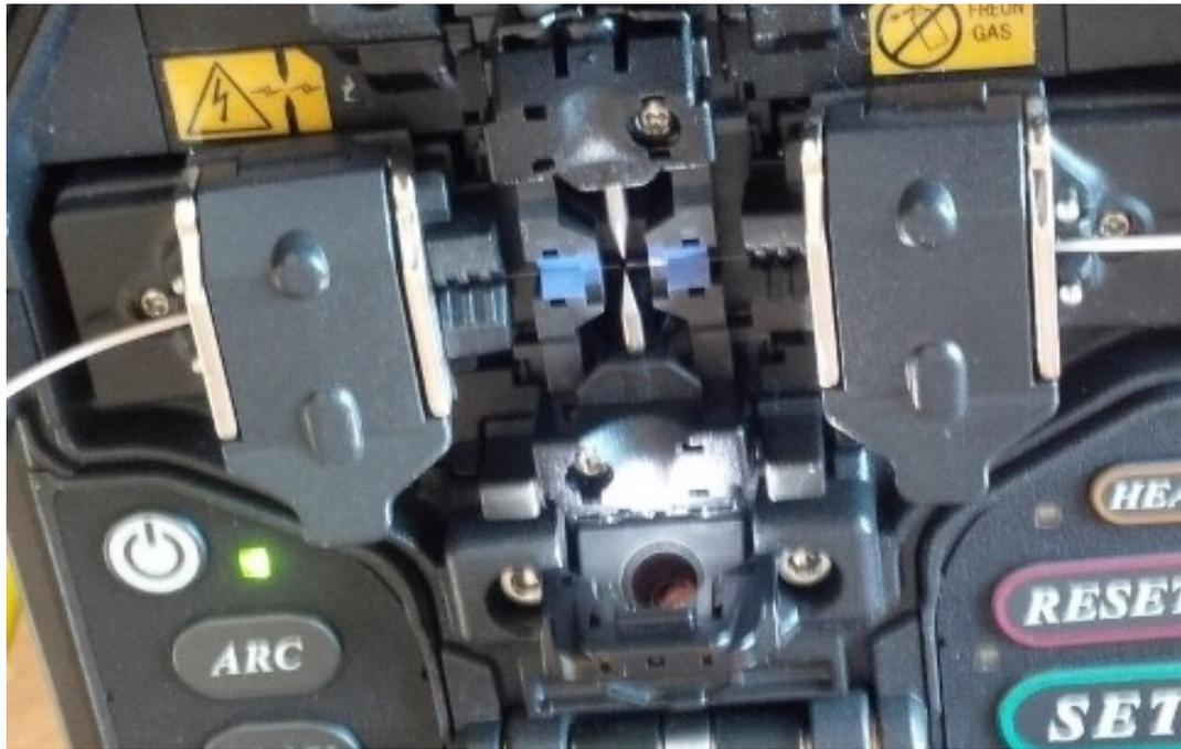
Spleißgerät mit Lichtwellenleitern, die so nah wie möglich zu den Spleißelektroden angeordnet sind und von Federklemmen in Position gehalten werden.
