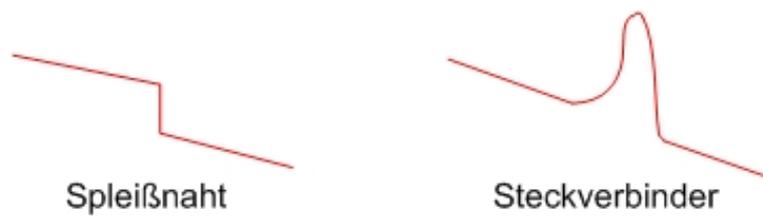
Steckverbinder und Spleißnähte, in OTDR angezeigt.
