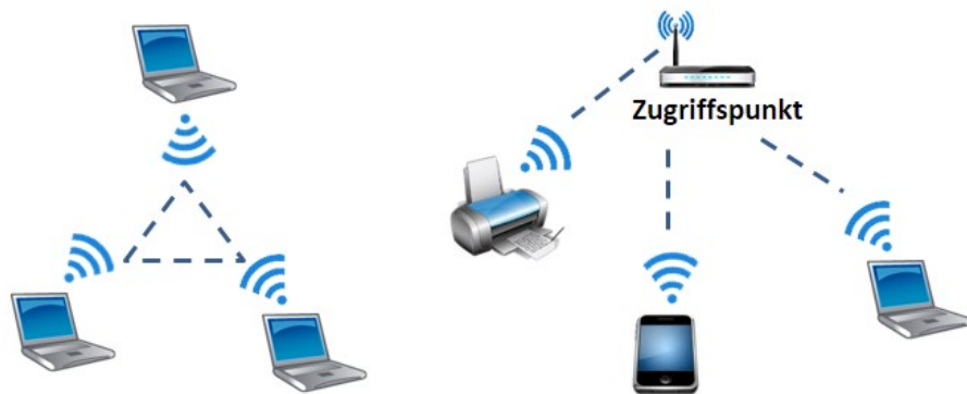
Bild 1.9 Unabhängiger und Infrastruktur-Basisdienstleistungssatz BSS
