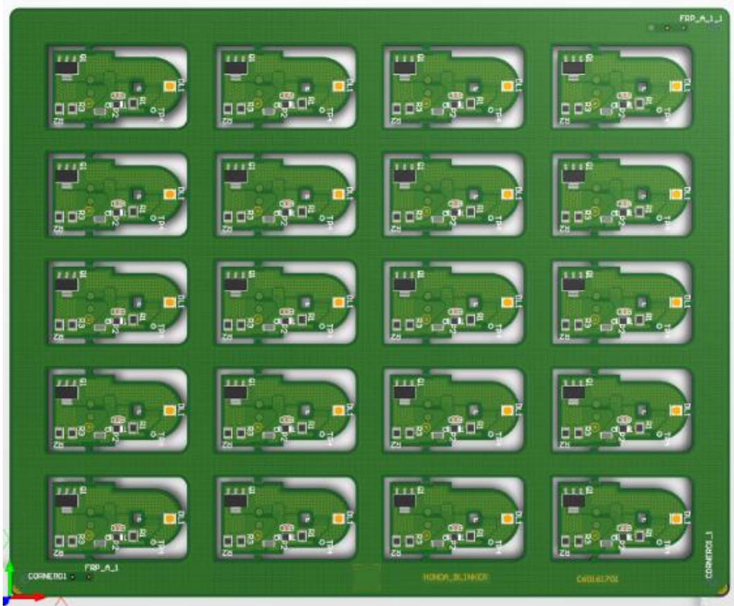
Fig. 15. Diseño del panel de producción.
