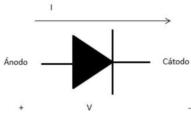
Fig. 8. Símbolo electrónico del diodo.
