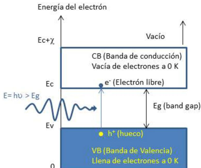
Fig. 6. Mecanismo de absorción y diagrama de bandas de energía.
