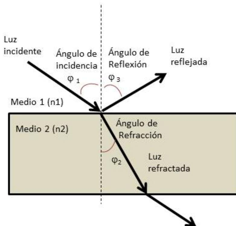
Fig. 2. Angulos de reflexión y refracción.
