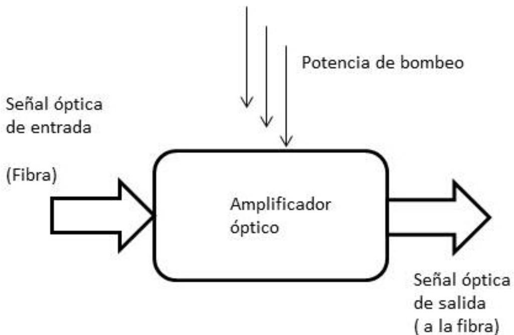
Fig. 12. Esquema de amplificador óptico.
