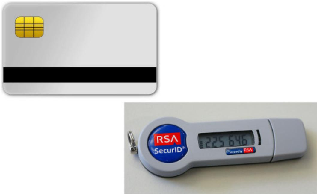
Fig. 2. Ejemplos de *tokens* de hardware para el tipo de autenticación "Algo que tienes".
