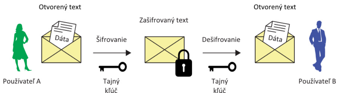
Obr 2.1 Model kryptografie s tajným kľúčom
