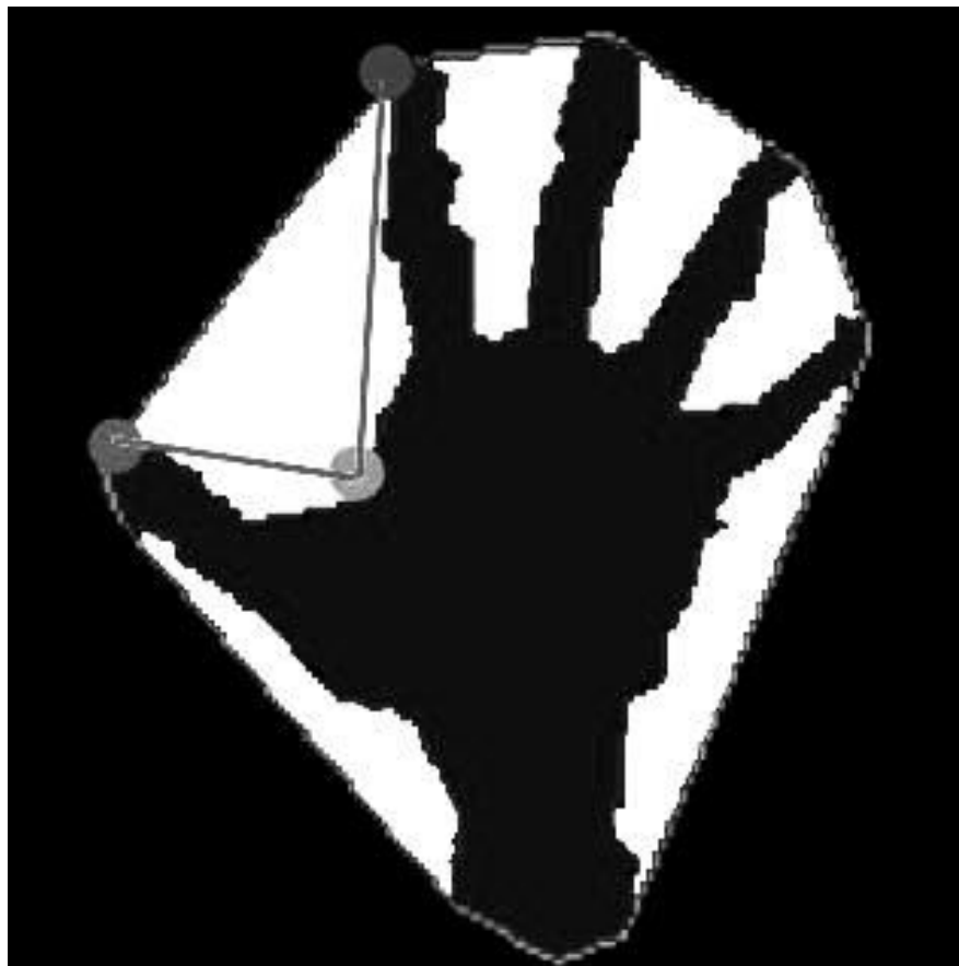
Abb. 4.4 - Der markierte Bereich stellt die konvexen Defekte dar und besteht aus drei Punkten: Ausgangspunkt (links), der tiefste Punkt (unten) und Endpunkt (oben)
