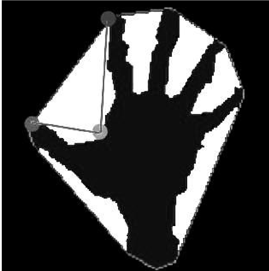
Obrázek 4.4 Označená oblast jsou konvexní nedostatky a tři body: počáteční bod (vlevo), nejhlubší bod (dole) a koncový bod (nahore)
