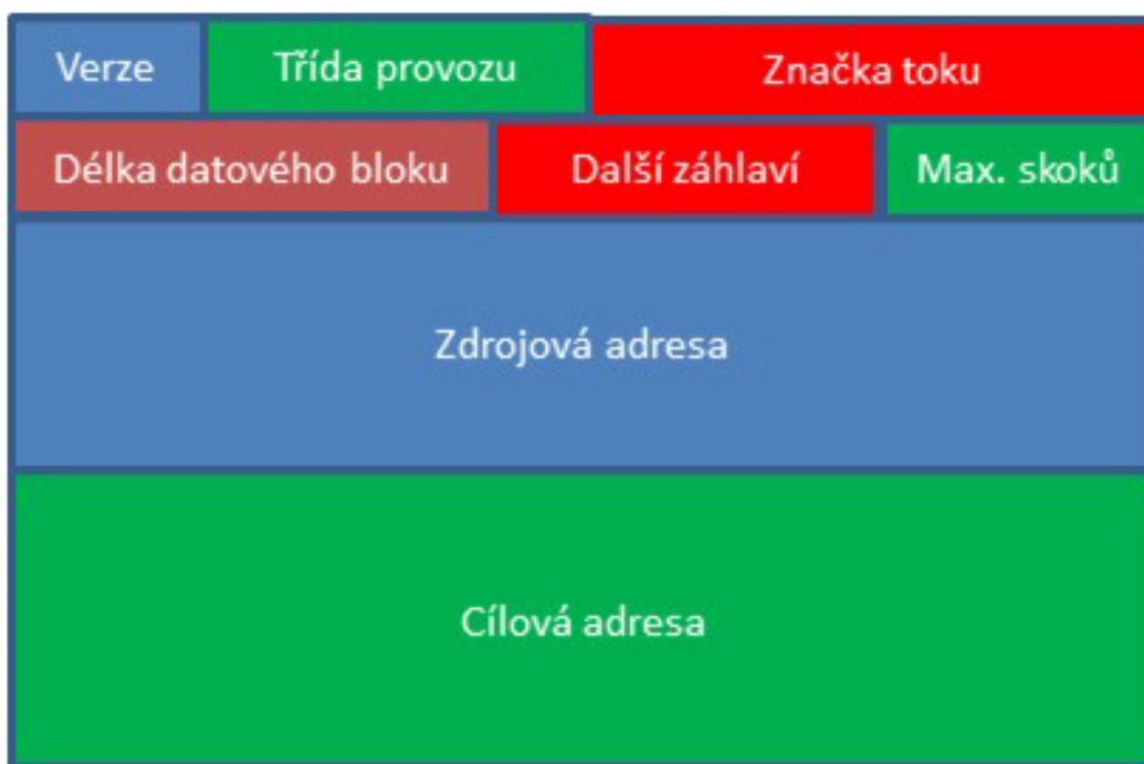
Obr. 1. Formát záhlaví protokolu IPv6 [3]
