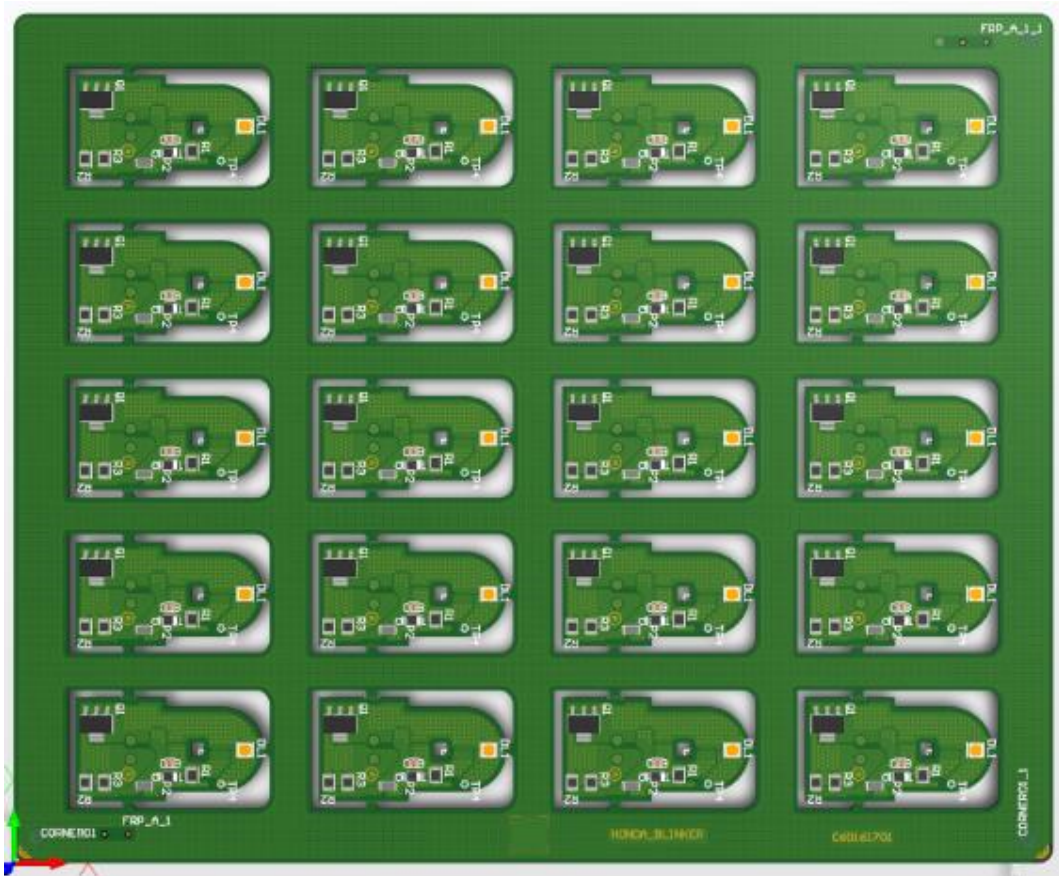
Obr. 15. Návrh výrobního panelu s deskami.
